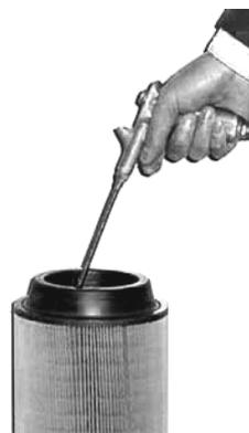
**Рис. 6.3 Очистка фильтрующего элемента воздушного фильтра**
